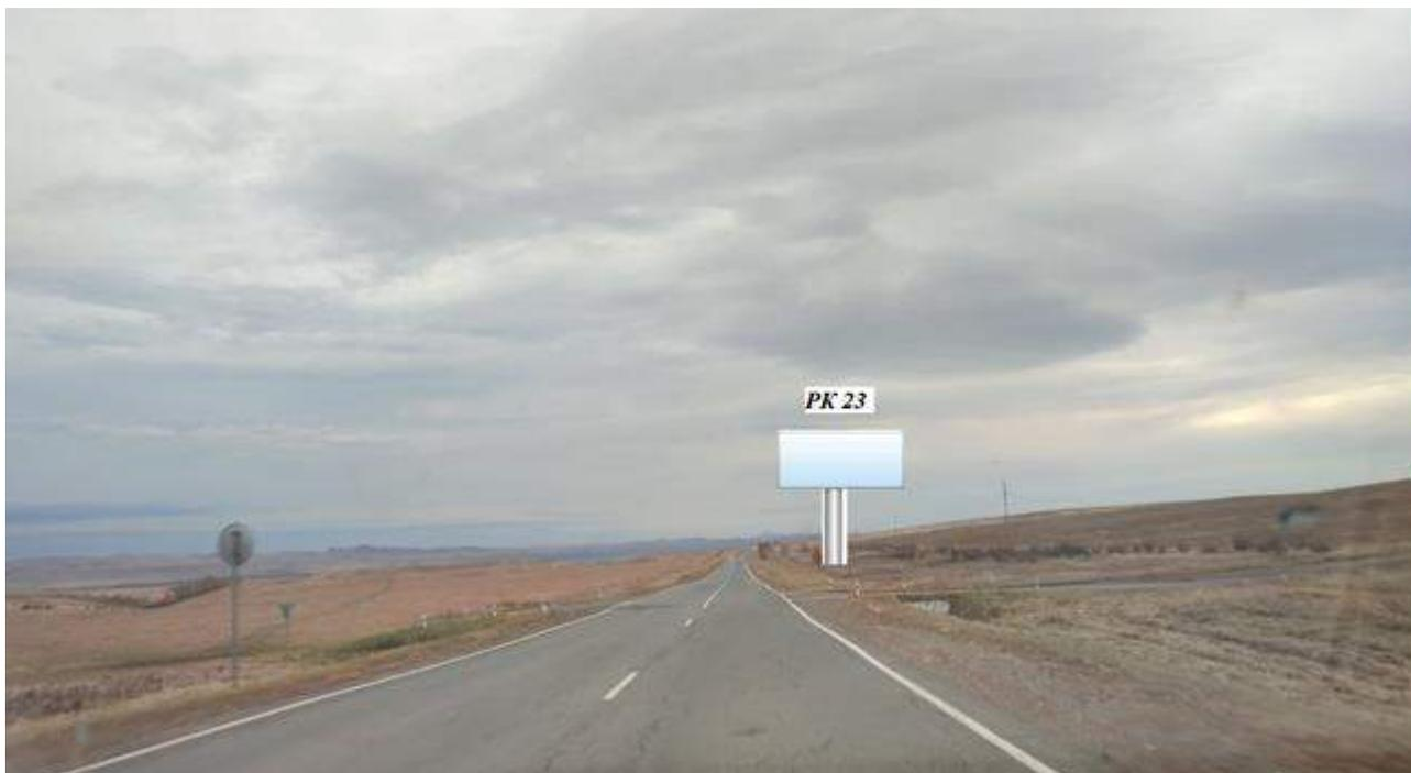
1. Расстояние сбоку от автомобильной дороги на расстоянии от бровки земляного полотна (внешней границы обочины) до ближайшей точки горизонтальной проекции внешнего конструктивного элемента средства наружной рекламы 11 м. Расстояние от перекрестка 350 м.
