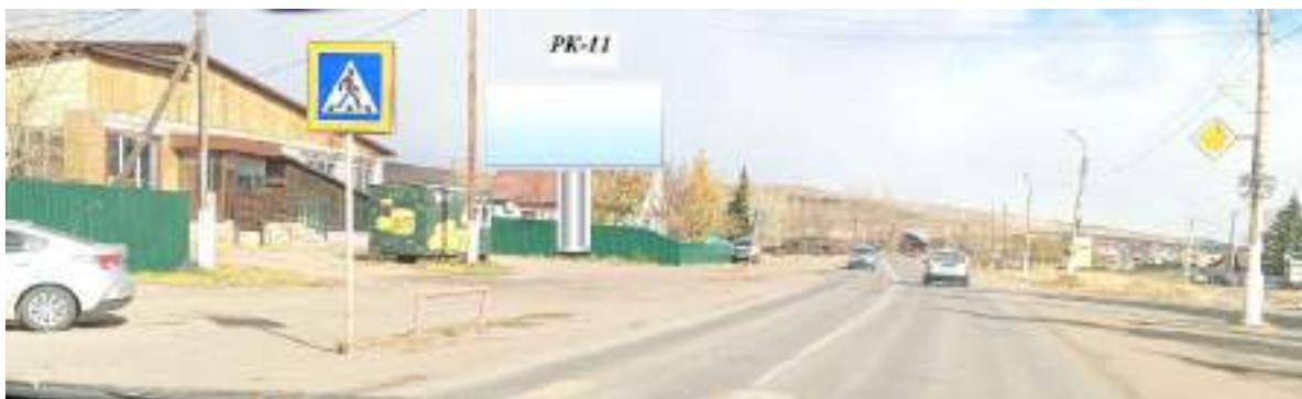
1. Расстояние сбоку от автомобильной дороги на расстоянии от бровки земляного полотна (внешней границы обочины) до ближайшей точки горизонтальной проекции внешнего конструктивного элемента средства наружной рекламы 4,5 м
