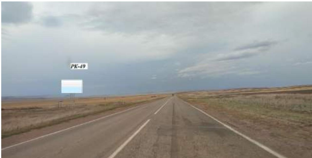
1. Расстояние сбоку от автомобильной дороги на расстоянии от бровки земляного полотна (внешней границы обочины) до ближайшей точки горизонтальной проекции внешнего конструктивного элемента средства наружной рекламы 11 м
