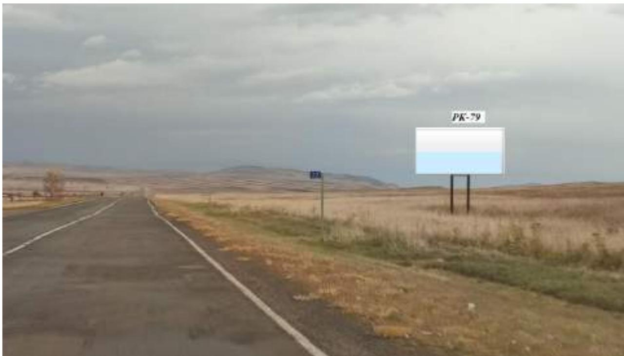
1. Расстояние сбоку от автомобильной дороги на расстоянии от бровки земляного полотна (внешней границы обочины) до ближайшей точки горизонтальной проекции внешнего конструктивного элемента средства наружной рекламы 11 м
