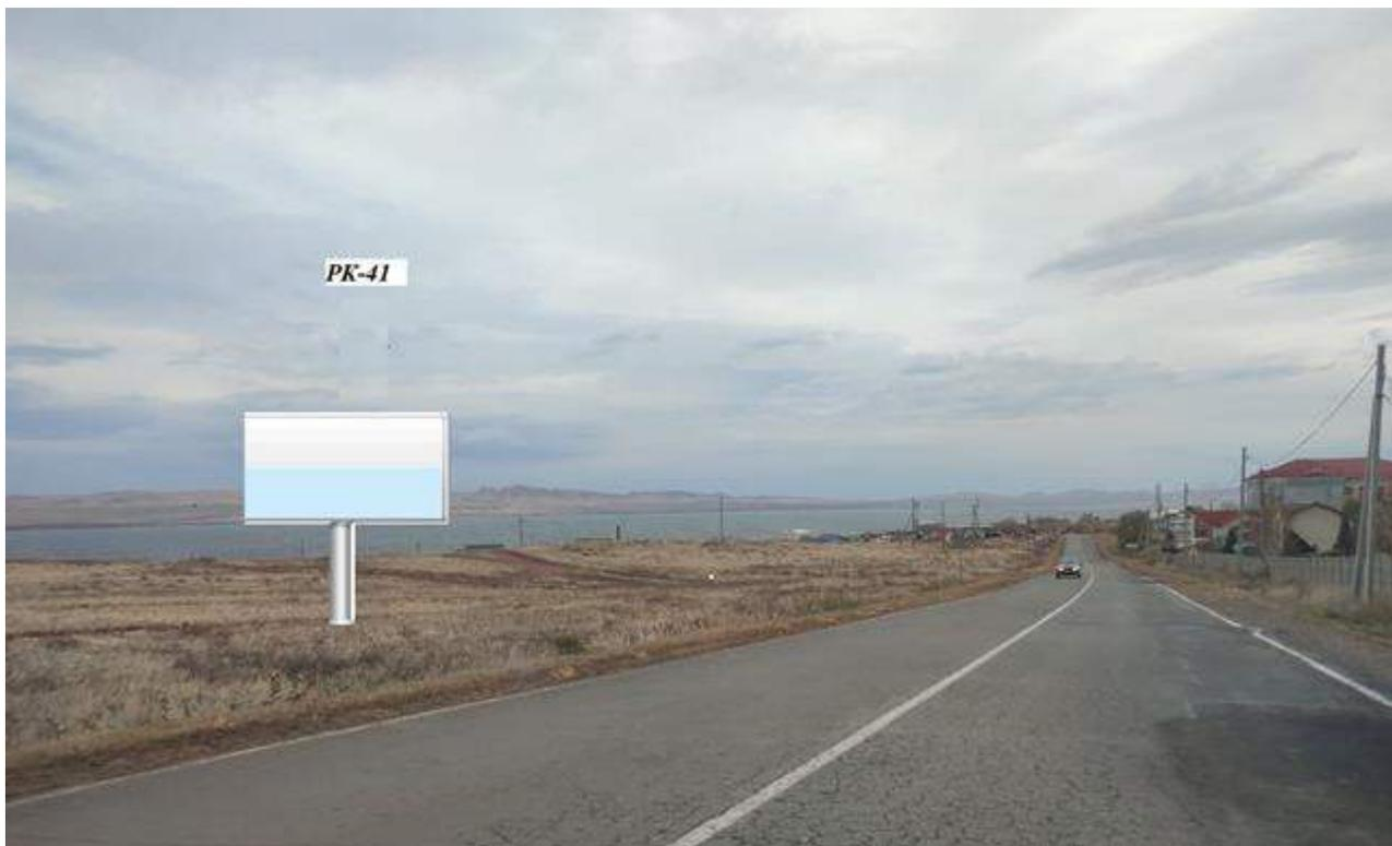
1. Расстояние сбоку от автомобильной дороги на расстоянии от бровки земляного полотна (внешней границы обочины) до ближайшей точки горизонтальной проекции внешнего конструктивного элемента средства наружной рекламы 15 м
