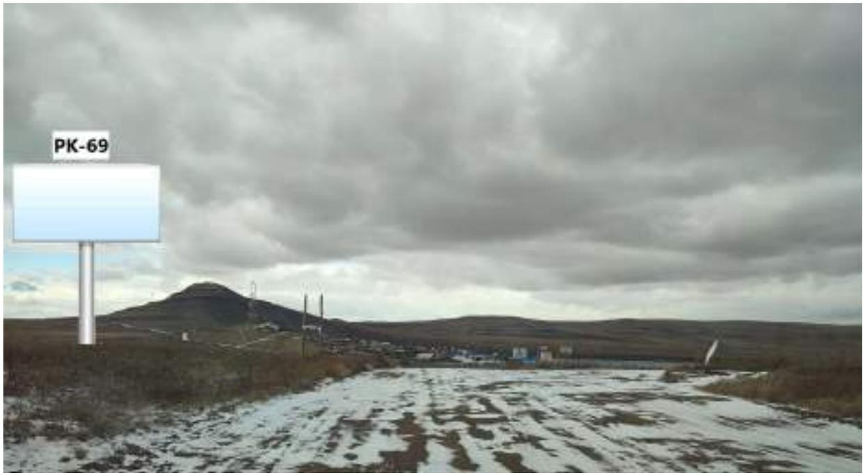
1. Расстояние сбоку от автомобильной дороги на расстоянии от бровки земляного полотна (внешней границы обочины) до ближайшей точки горизонтальной проекции внешнего конструктивного элемента средства наружной рекламы 10 м
