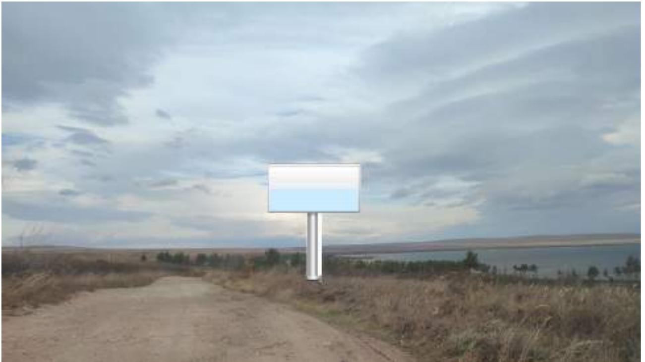
1. Расстояние сбоку от автомобильной дороги на расстоянии от бровки земляного полотна (внешней границы обочины) до ближайшей точки горизонтальной проекции внешнего конструктивного элемента средства наружной рекламы 2,5 м
