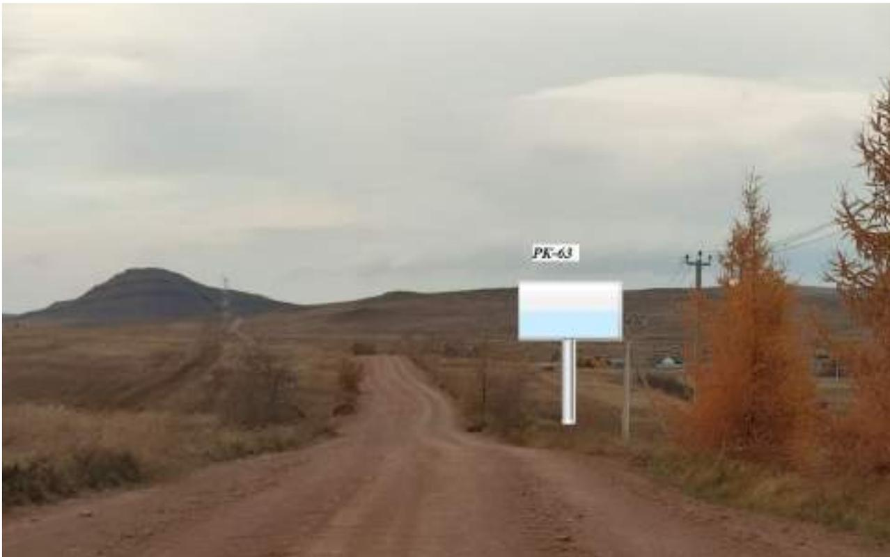
1. сбоку от автомобильной дороги на расстоянии от бровки земляного полотна (внешней границы обочины) до ближайшей точки горизонтальной проекции внешнего конструктивного элемента средства наружной рекламы 10 м
