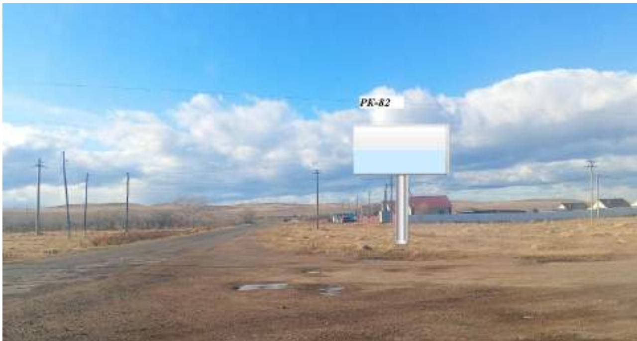
1. Расстояние сбоку от автомобильной дороги на расстоянии от бровки земляного полотна (внешней границы обочины) до ближайшей точки горизонтальной проекции внешнего конструктивного элемента средства наружной рекламы 6 м
