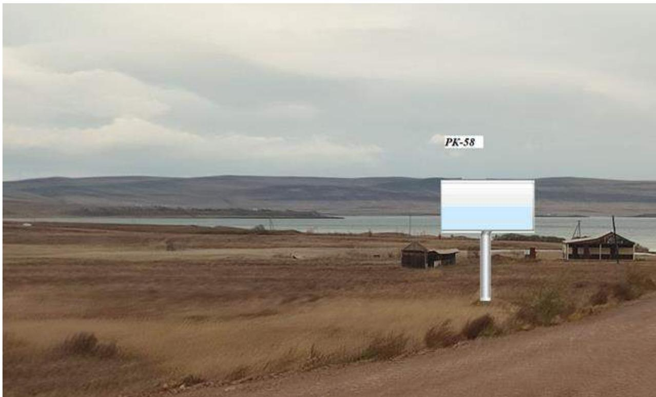
1. Расстояние сбоку от автомобильной дороги на расстоянии от бровки земляного полотна (внешней границы обочины) до ближайшей точки горизонтальной проекции внешнего конструктивного элемента средства наружной рекламы 10 м
