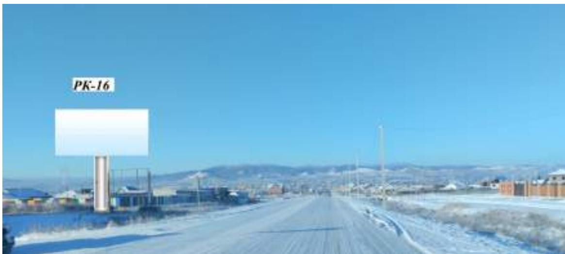
1. Расстояние сбоку от автомобильной дороги на расстоянии от бровки земляного полотна (внешней границы обочины) до ближайшей точки горизонтальной проекции внешнего конструктивного элемента средства наружной рекламы 8 м
