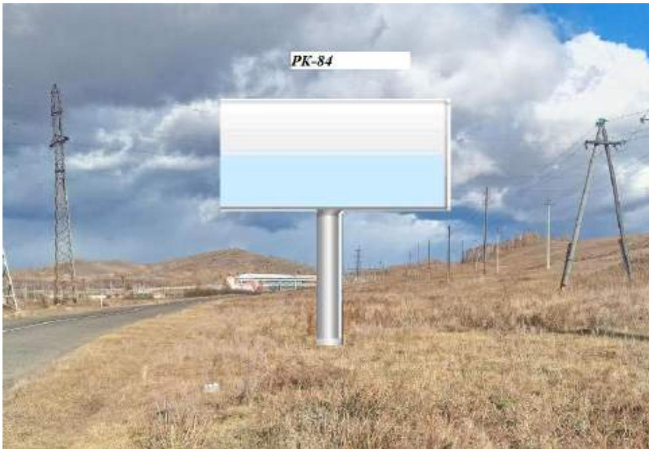
1. Расстояние сбоку от автомобильной дороги на расстоянии от бровки земляного полотна (внешней границы обочины) до ближайшей точки горизонтальной проекции внешнего конструктивного элемента средства наружной рекламы 4 м
