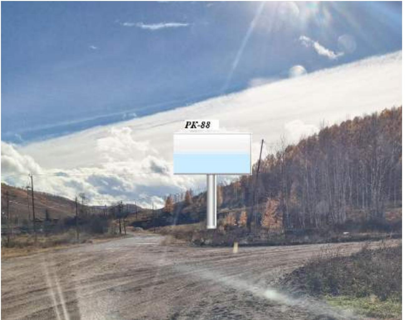
1. Расстояние сбоку от автомобильной дороги на расстоянии от бровки земляного полотна (внешней границы обочины) до ближайшей точки горизонтальной проекции внешнего конструктивного элемента средства наружной рекламы 4 м
