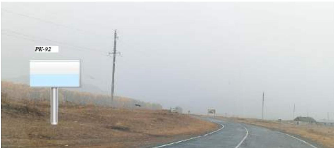
1. Расстояние сбоку от автомобильной дороги на расстоянии от бровки земляного полотна (внешней границы обочины) до ближайшей точки горизонтальной проекции внешнего конструктивного элемента средства наружной рекламы 11 м
