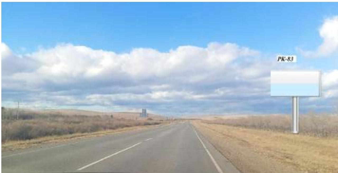
1. Расстояние сбоку от автомобильной дороги на расстоянии от бровки земляного полотна (внешней границы обочины) до ближайшей точки горизонтальной проекции внешнего конструктивного элемента средства наружной рекламы 12 м. Расстояние от перекрестка 350 м.
