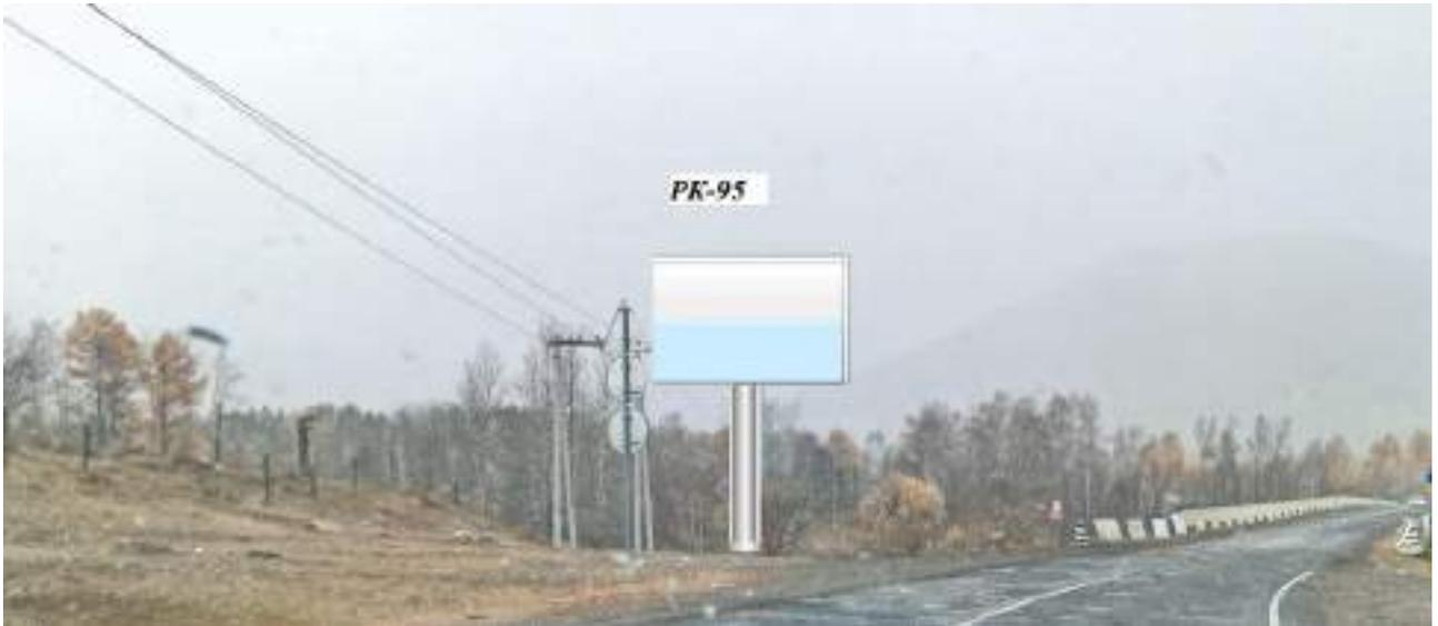
1. Расстояние сбоку от автомобильной дороги на расстоянии от бровки земляного полотна (внешней границы обочины) до ближайшей точки горизонтальной проекции внешнего конструктивного элемента средства наружной рекламы 12 м
