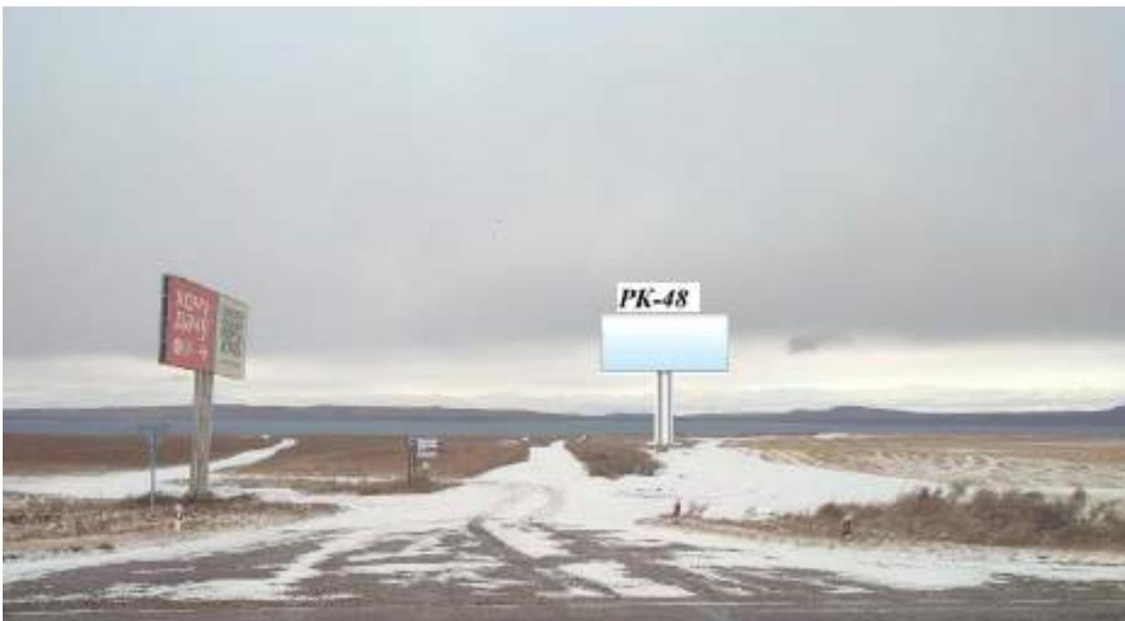
1. Расстояние сбоку от автомобильной дороги на расстоянии от бровки земляного полотна (внешней границы обочины) до ближайшей точки горизонтальной проекции внешнего конструктивного элемента средства наружной рекламы 24 м
