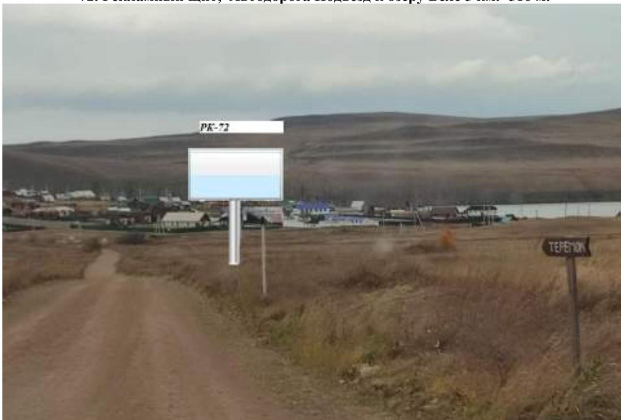
1. Расстояние сбоку от автомобильной дороги на расстоянии от бровки земляного полотна (внешней границы обочины) до ближайшей точки горизонтальной проекции внешнего конструктивного элемента средства наружной рекламы 10 м
