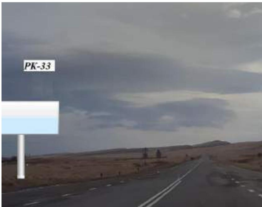
1. Расстояние сбоку от автомобильной дороги на расстоянии от бровки земляного полотна (внешней границы обочины) до ближайшей точки горизонтальной проекции внешнего конструктивного элемента средства наружной рекламы 11 м.
