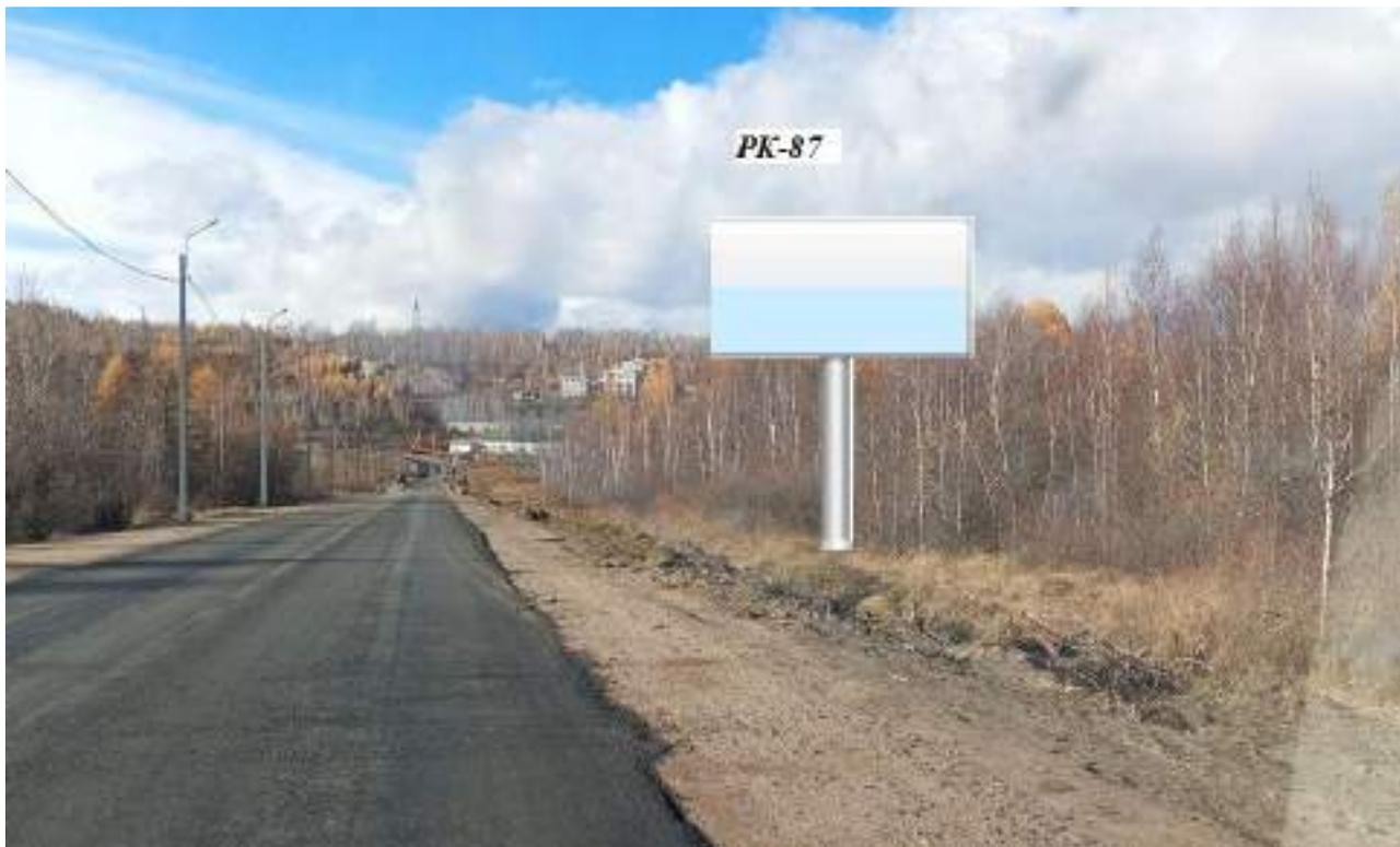
1. Расстояние сбоку от автомобильной дороги на расстоянии от бровки земляного полотна (внешней границы обочины) до ближайшей точки горизонтальной проекции внешнего конструктивного элемента средства наружной рекламы 9 м
