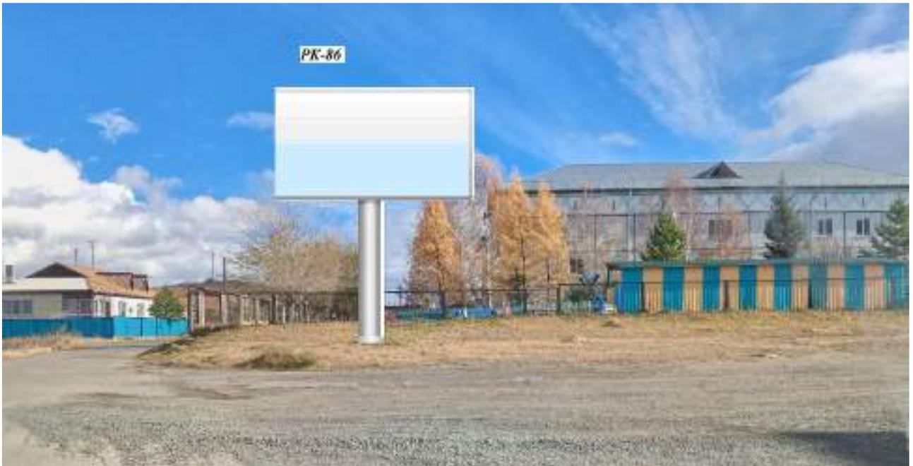
1. Расстояние сбоку от автомобильной дороги на расстоянии от бровки земляного полотна (внешней границы обочины) до ближайшей точки горизонтальной проекции внешнего конструктивного элемента средства наружной рекламы 4 м
