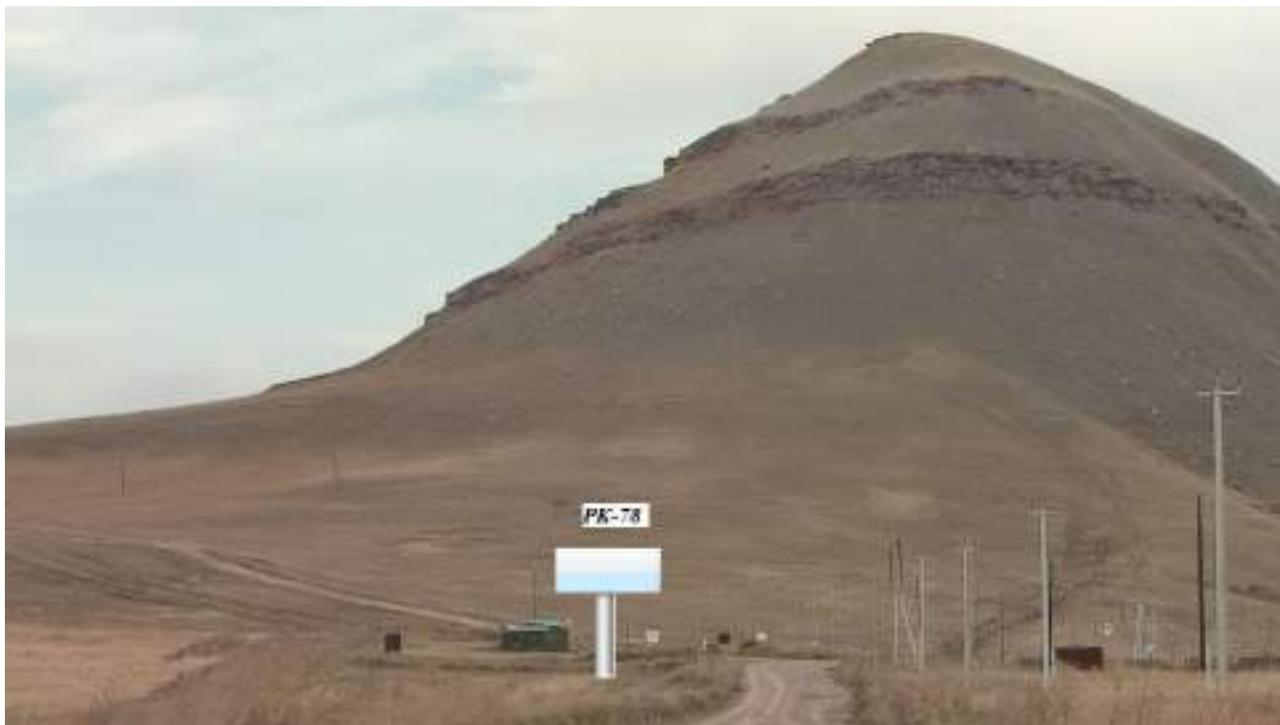
1. Расстояние сбоку от автомобильной дороги на расстоянии от бровки земляного полотна (внешней границы обочины) до ближайшей точки горизонтальной проекции внешнего конструктивного элемента средства наружной рекламы 10 м
