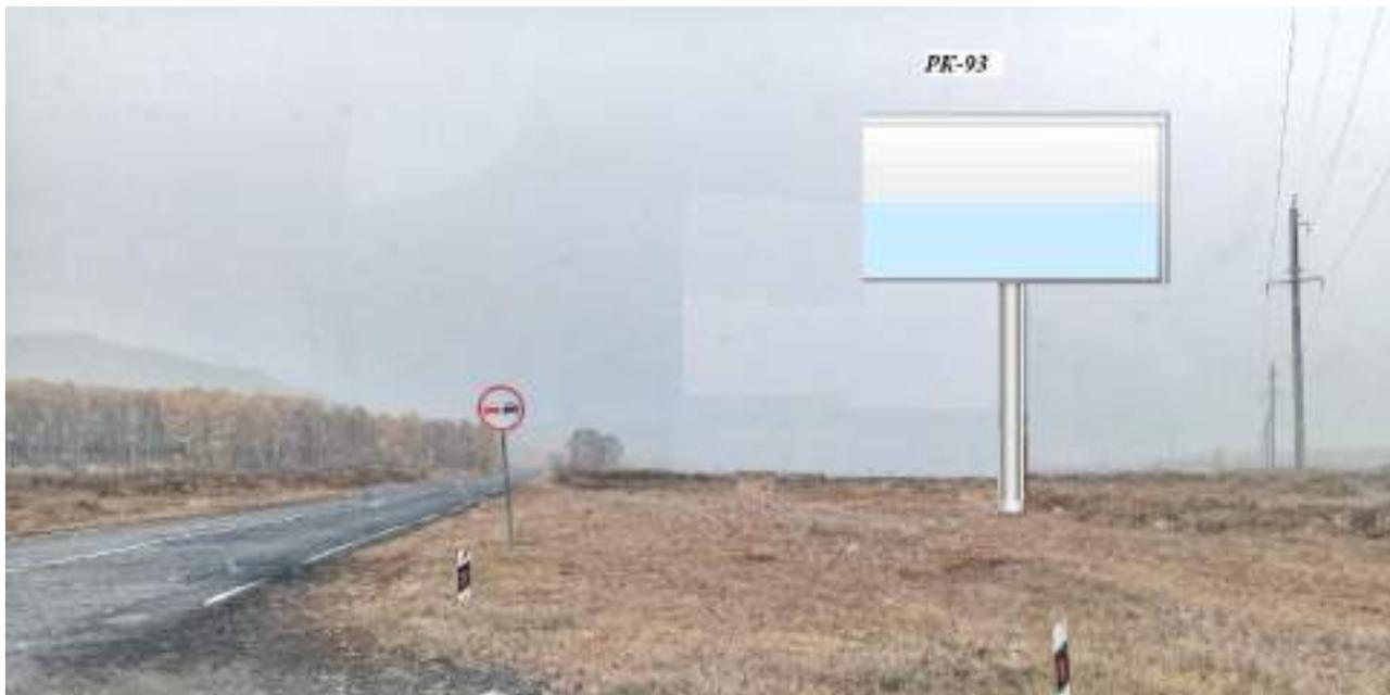
1. Расстояние сбоку от автомобильной дороги на расстоянии от бровки земляного полотна (внешней границы обочины) до ближайшей точки горизонтальной проекции внешнего конструктивного элемента средства наружной рекламы 12 м
