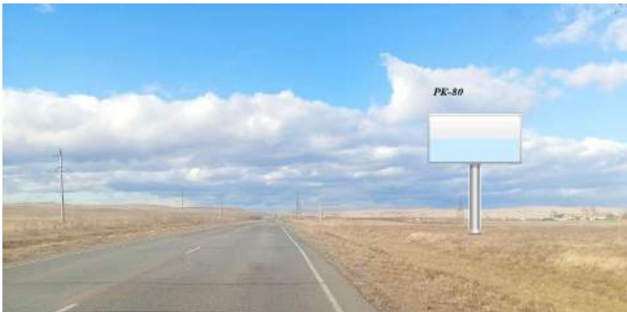
1. Расстояние сбоку от автомобильной дороги на расстоянии от бровки земляного полотна (внешней границы обочины) до ближайшей точки горизонтальной проекции внешнего конструктивного элемента средства наружной рекламы 16 м
