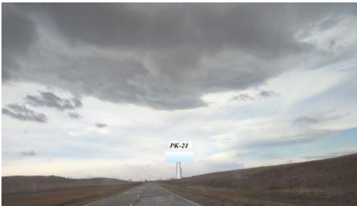
1. Расстояние сбоку от автомобильной дороги на расстоянии от бровки земляного полотна (внешней границы обочины) до ближайшей точки горизонтальной проекции внешнего конструктивного элемента средства наружной рекламы 15 м. Расстояние от перекрестка 350 м.
