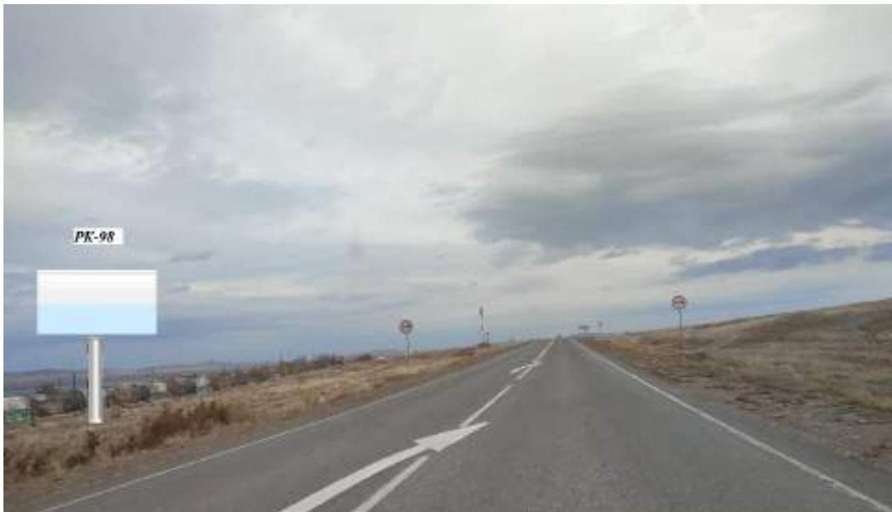
1. Расстояние сбоку от автомобильной дороги на расстоянии от бровки земляного полотна (внешней границы обочины) до ближайшей точки горизонтальной проекции внешнего конструктивного элемента средства наружной рекламы 12 м
