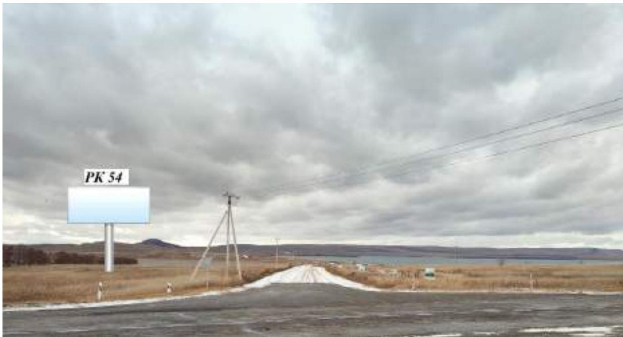
1. Расстояние сбоку от автомобильной дороги на расстоянии от бровки земляного полотна (внешней границы обочины) до ближайшей точки горизонтальной проекции внешнего конструктивного элемента средства наружной рекламы 14 м
