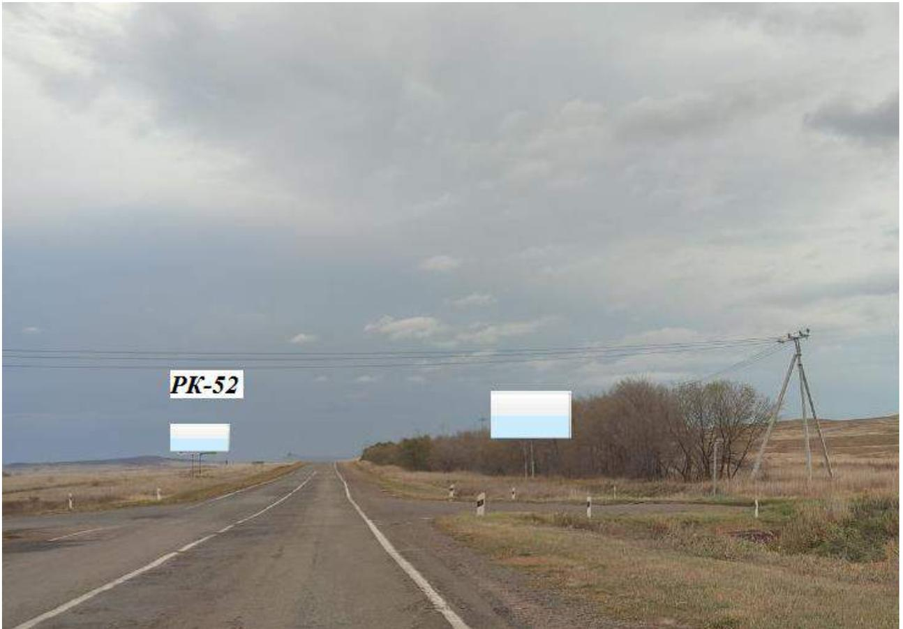
1. Расстояние сбоку от автомобильной дороги на расстоянии от бровки земляного полотна (внешней границы обочины) до ближайшей точки горизонтальной проекции внешнего конструктивного элемента средства наружной рекламы 11 м. Расстояние от перекрестка 350 м.
