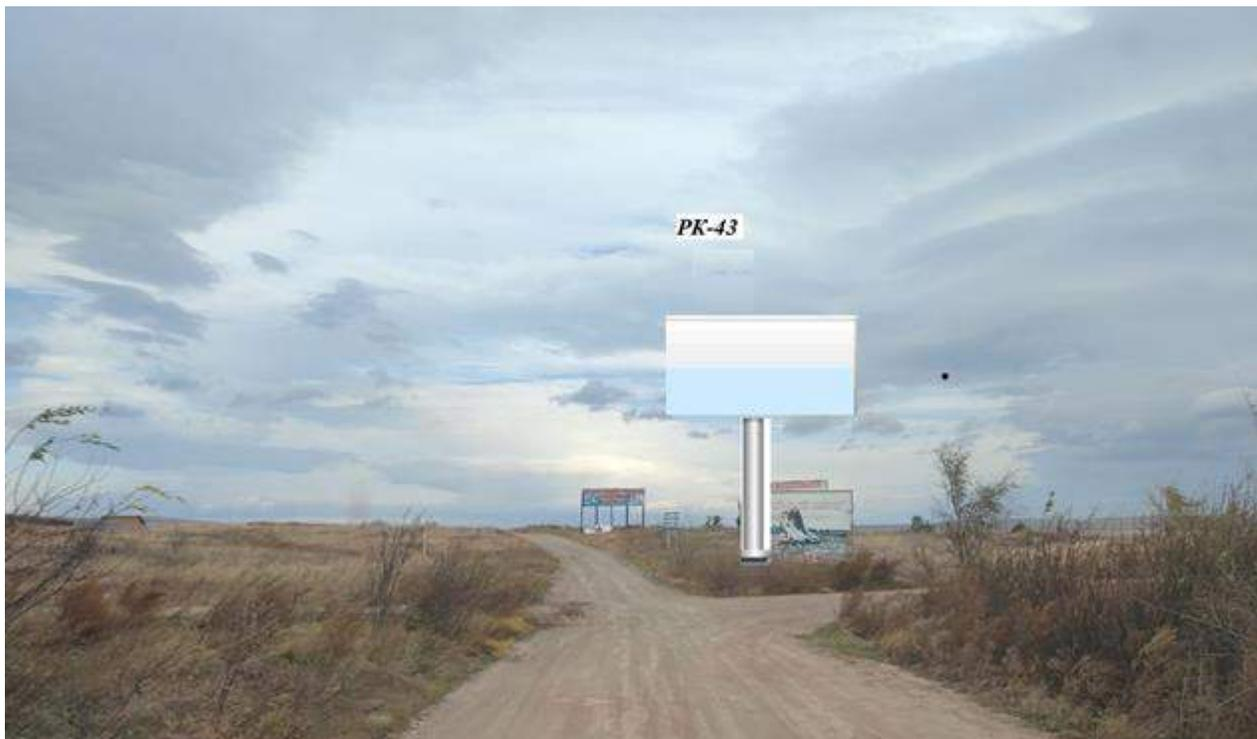
1. Расстояние сбоку от автомобильной дороги на расстоянии от бровки земляного полотна (внешней границы обочины) до ближайшей точки горизонтальной проекции внешнего конструктивного элемента средства наружной рекламы 2,5 м
